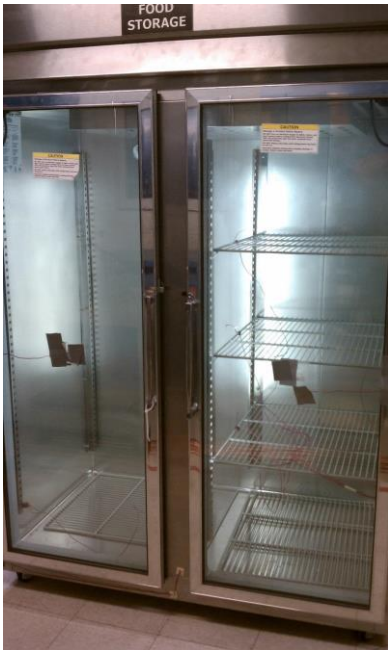
Figura 1: Congelatore commerciale alimentato con R-404A utilizzato nei test sperimentali
