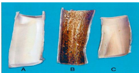
A: Tubo evaporatore nuovo B: Tubo evaporatore non trattato dopo 400 ore di operatività C: Tubo evaporatore trattato con additivo dopo 400 ore di operatività
